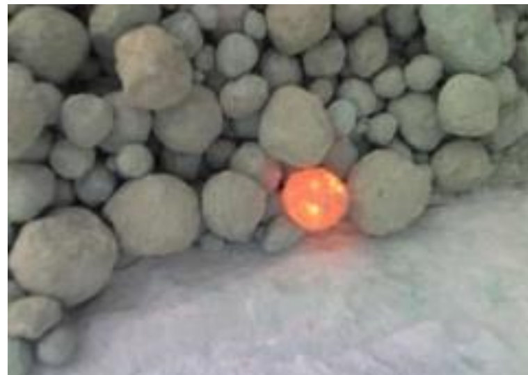
Mâchefer métallurgique à la sortie du four
